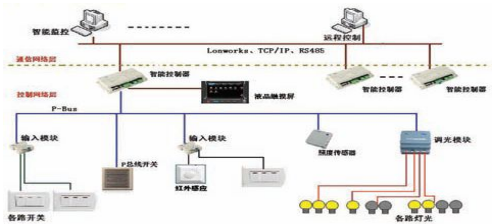
图 1 总线制智能照明控制系统
